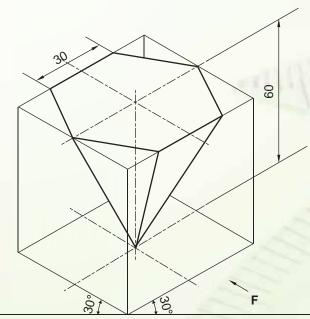
Fig 1.16 ISOMETRIC PROJECTION
