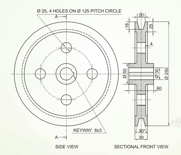
SINGLE GROOVE V - BELT PULLEY Fig 7.10 PULLEYS
